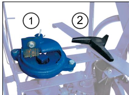
**1 – Distribuição de semente:** Discos perfurado posicionado na horizontal em ferro fundido, conforme a semente a diversos tamanhos de furo, possui um limitador de semente e um empurrador proporcionando um semeado uniforme.
